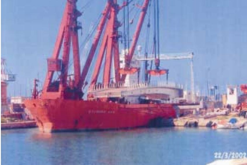
Fig. 8 - Inizio manovra di sbarco del ponte metallico con sollevamento dalla nave
